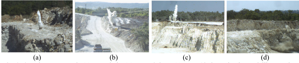
Şekil 6. Patlatma sırasında (a) Atım 2'de, (b) Atım 6'da ve (c) Atım 12'de gözlemlenen delik ağzından gaz püskürmesi ile (d) Atım 4'te delik ağzından gaz kaçışının kontrol altına alınması
