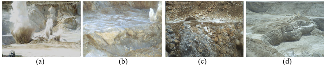
Şekil 7. Patlatma sırasında (a) Atım 7'de ve (b) Atım 8'de gözlemlenen delik ağzından gaz püskürmesi, (c) Atım 12'de ve (d) Atım 14'te delik ağzından gaz kaçışının kontrol altına alınması
