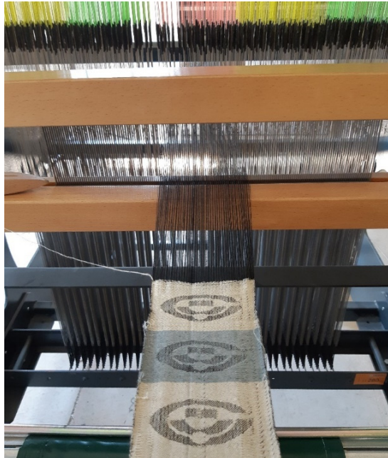
Şekil 11. Dokuma tarağı ve tefe mekanizması
