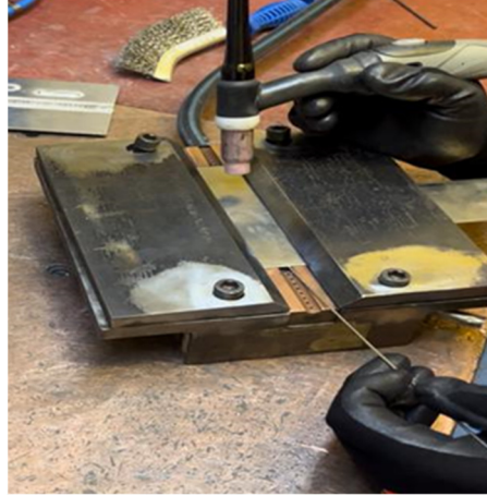
Şekil 2. Kök gazı kullanarak TIG kaynak yöntemi ile AW 6061 malzemenin birleştirme işlemi
