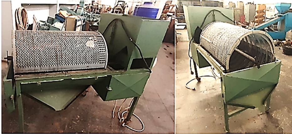
Şekil 1. Simülasyonu yapılan fıstık tasnif makinası
